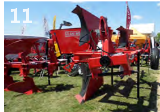
Különleges, mélyen szántó váltvaforogató eke
