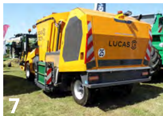
Nagyobb tehenészeti telepeket kiszolgáló magajáró keverő-kiosztó kocsik
