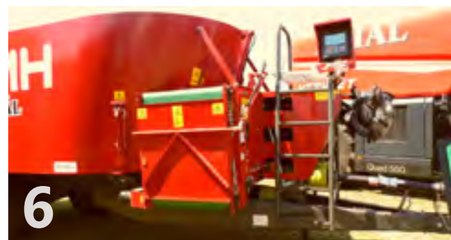
Elektromos mérleggel, érintőképernyős kijelzővel szerelt vontatott keverő-kiosztó kocsik
